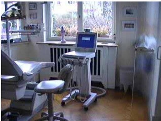
TFT-Flachbildschirm-Montage an Ritter-Cart, befestigt über hydraulisch gefederten 3-Punkt-Gelenkschwenkarm
