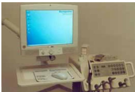
TFT-Flachbildschirmmontage bei Sirona anstelle der Sivation durch Spezialhalterung
